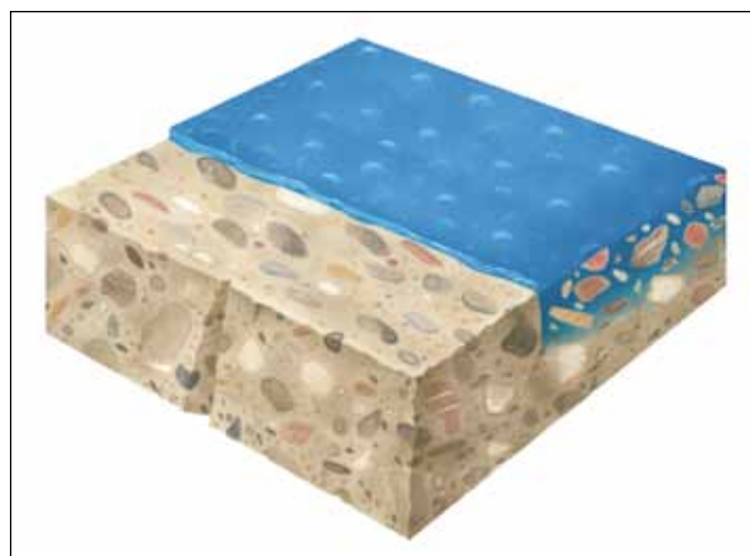
Působení speciální penetrace ASODUR-SG2
